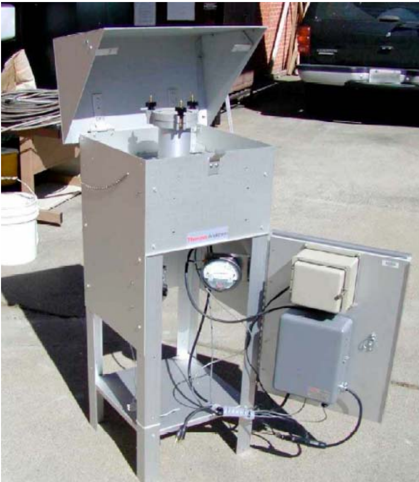
Obr. 3: Velkoobjemové vzorkovací zařízení pro odběry ovzduší Andersen Instruments (až 1500 m 3 / 24 h)
