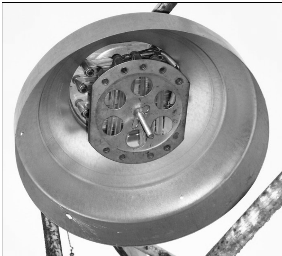
Obr. 5: SPMD zařízení pro pasivní vzorkování ovzduší
